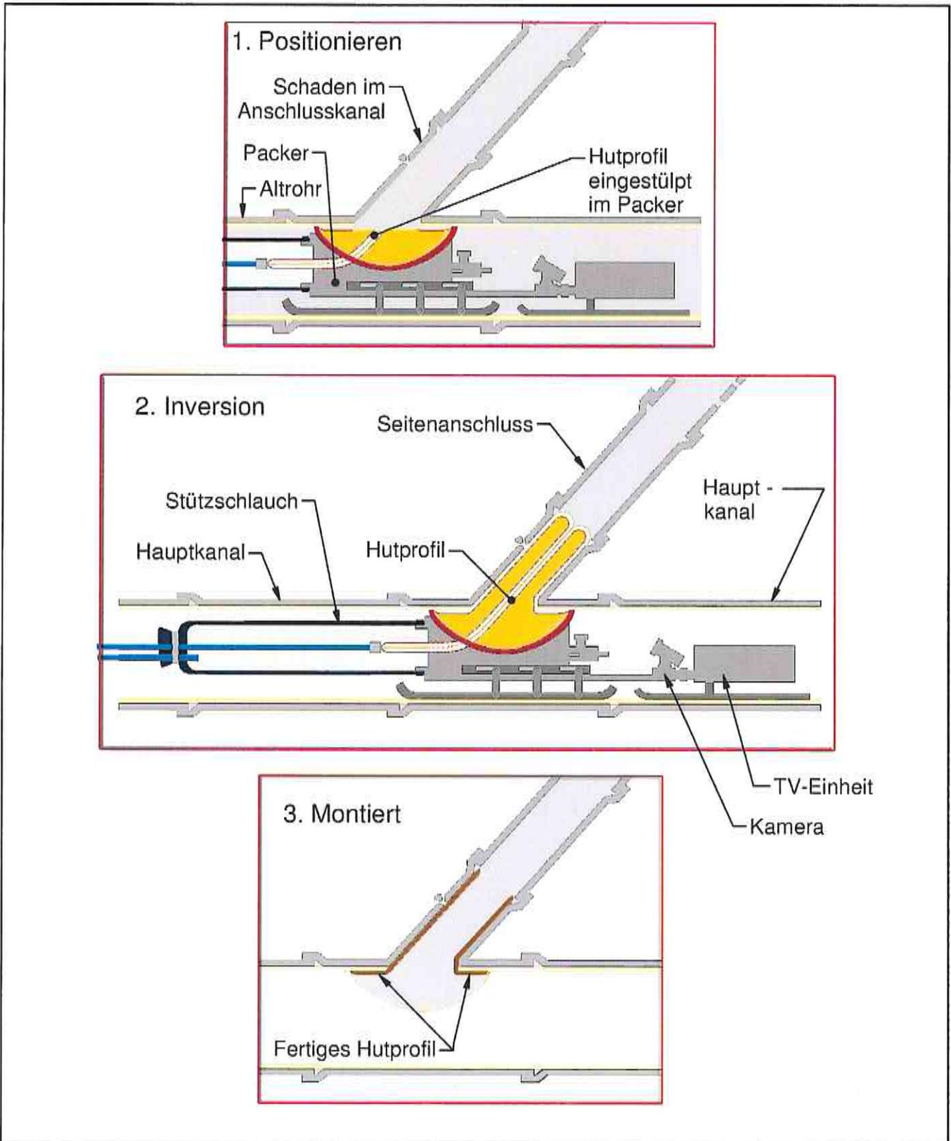
Bauprodukte und deren Verwendung zur Ausführung von Schlauchlinern zur Sanierung schadhafter erdverlegter Abwasserkanäle und -leitungen mit Ei- und Kreisprofilen mit den Bezeichnungen PAA-G-Liner, PAA-G+Liner und PAA-GL-Liner im Nennweitenbereich von DN 150 bis DN 1200, PAA-EG-Liner im Nennweitenbereich von DN 150 bis DN 600 und PAA-G3-Liner im Nennweitenbereich DN 100 bis 300
