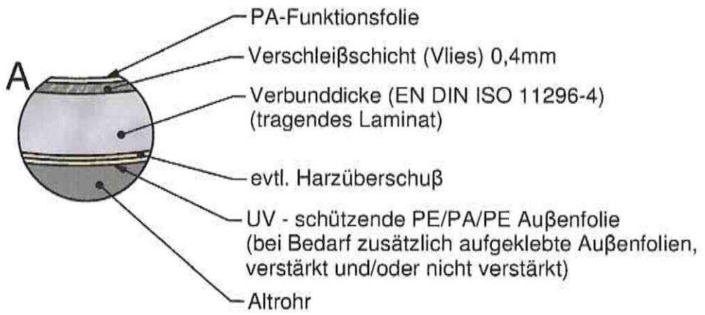
Bauprodukte und deren Verwendung zur Ausführung von Schlauchlinern zur Sanierung schadhafter erdverlegter Abwasserkanäle und -leitungen mit Ei- und Kreisprofilen mit den Bezeichnungen PAA-G-Liner, PAA-G+-Liner und PAA-GL-Liner im Nennweitenbereich von DN 150 bis DN 1200, PAA-EG-Liner im Nennweitenbereich von DN 150 bis DN 600 und PAA-G3-Liner im Nennweitenbereich DN 100 bis 300
