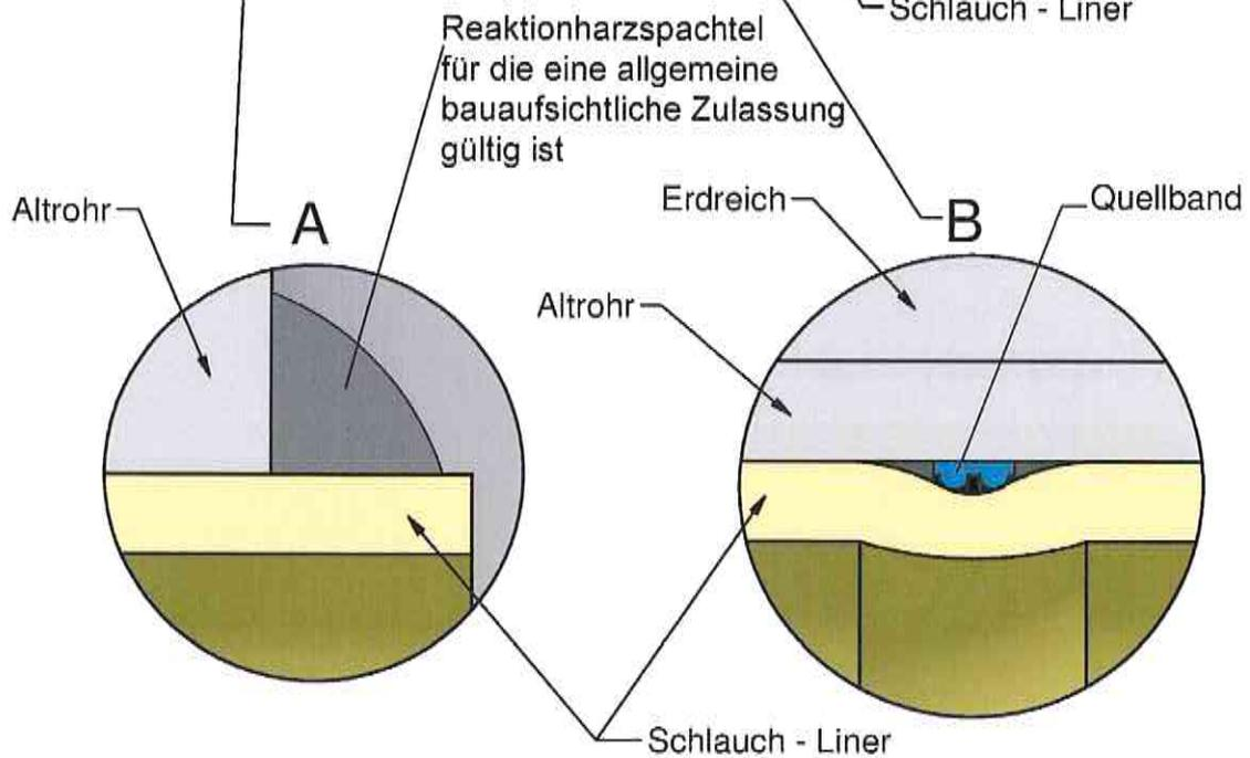
Bauprodukte und deren Verwendung zur Ausführung von Schlauchlinern zur Sanierung schadhafter erdverlegter Abwasserkanäle und -leitungen mit Ei- und Kreisprofilen mit den Bezeichnungen PAA-G-Liner, PAA-G+-Liner und PAA-GL-Liner im Nennweitenbereich von DN 150 bis DN 1200, PAA-EG-Liner im Nennweitenbereich von DN 150 bis DN 600 und PAA-G3-Liner im Nennweitenbereich DN 100 bis 300
