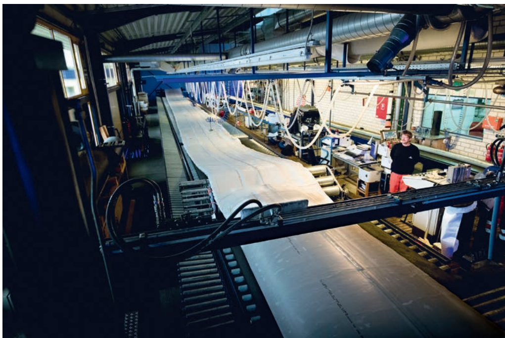
Die Imprägnierung des 409 Meter langen Liners mit 56 Tonnen Harz dauerte 26 Stunden. Foto: Aarsleff
