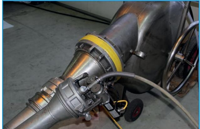
Fahrbare Drucktrommel zur Inversion mit Zugang für LED-Strahler
