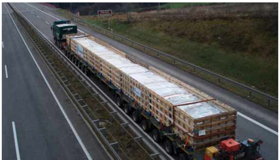
Der Transport der zum Teil Tonnen schweren Liner auf die Baustellen ist immer wieder auch eine logistische Herausforderung.
